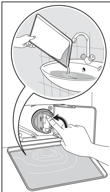
5. 将疏水管退回原位，然后旋转过滤器以将其取下。
