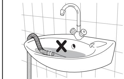
采用这种方式时，请确保出水端不会在洗衣机排水过程中脱落。要做到这一点，可将排水软管系在水龙头上或固定在墙上。
