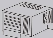
2、用吸塵機清除隔塵網灰塵較多的一面上的灰塵。
