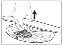
2. 在流动的水下清洗喷淋臂。使用一个又细 又尖的工具,例如牙签,以剔出洞眼里的 食物残渣颗粒。
