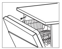
AirDry (空气对流干燥) 与所有程序一起自动启动,但 ‴ 除外(若适用)。
