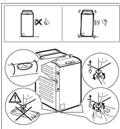
正確調整本機，以防止本機在運行時發生振動、噪音和移動。
