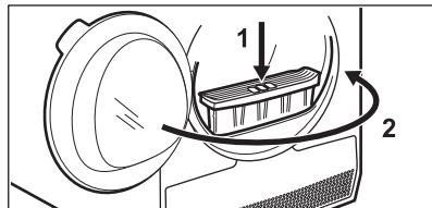
1) 必要时，请清理过滤器插座和垫圈之间的绒毛。您可以使用吸尘器。
