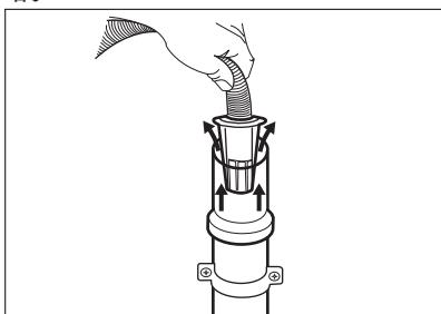
4. 若要將管道固定在通氣孔 - 將排水軟管直接插入排水管道中。請參閱圖例。
