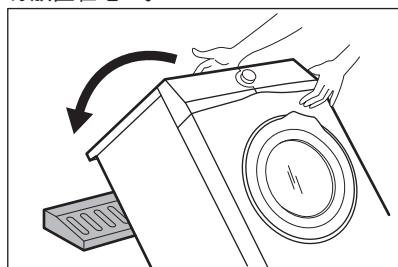
5. 拆除底部聚苯乙烯保護膜
