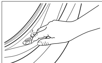
必要時進行清潔，使用氨霜清潔劑，以免刮傷密封圈表面。
