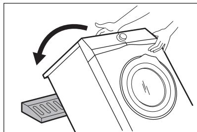
5. 拆除底部聚苯乙烯保護膜
