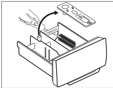
3. 確定已經從凹槽的上方和下方移除所有洗衣劑殘留物。使用小刷子清潔凹槽。
