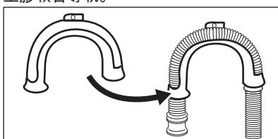
2. 在水槽邊緣處 - 將導軌固定在水龍頭或牆壁。
