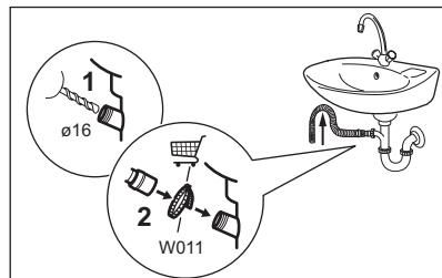
將排水軟管連接到排水龍頭上，並以扣夾固定。請確定排水軟管形成環路，以避免塵粒從水槽進入本機。
