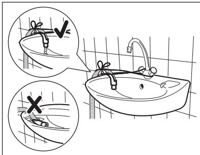
**i** 當本機排水且排水軟管末端未浸入水中時，確保塑料導軌不能移動。這可能導致髒水回流至本機。
