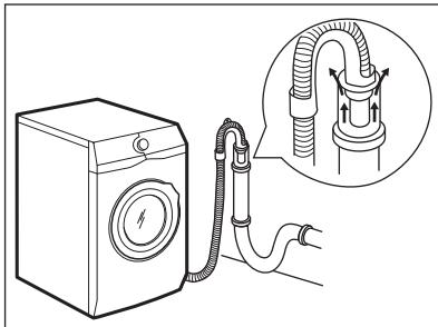
**i** 排水軟管的末端必須保持通風，即排水管道的內徑 (最小 38 公釐 - 最小 1.5 吋) 必須大於排水軟管的外徑。
