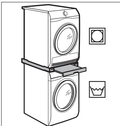
可將滾筒乾衣機疊置在洗衣機上方，但只能使用 ELECTROLUX 生產和核准的正確疊置套裝工具。
