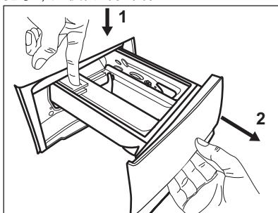
2. 移除添加劑盛載格的頂端部分，以協助在注入持續流動的溫水時，清潔和沖出添加劑，以移除累積洗衣劑的任何殘留物。清潔之後，將頂端部分放回原位。
