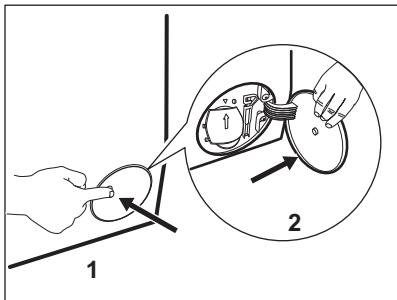
2. 將適當的碗放在排水泵出水口下方，以收集流出的水分。
