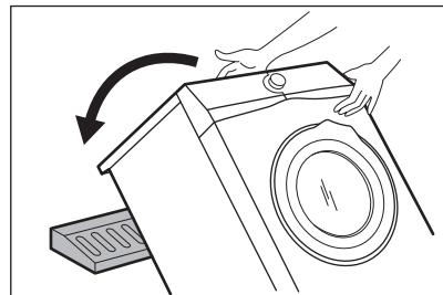
5. 拆除底部聚苯乙烯保護膜將本機重新放回直立位置。
