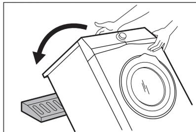
5. 拆除底部聚苯乙烯保護膜
