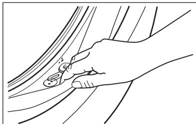
必要時進行清潔，使用氨霜清潔劑，以免刮傷密封圈表面。
